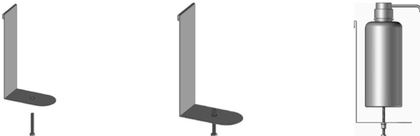
2. Dévisser la pompe du bidon. Fixer le bidon sur le couvercle de la borne.
