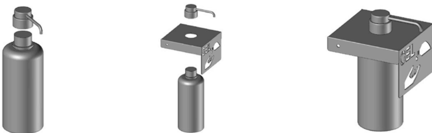
3. Positionner le support dans la borne. Centrer le support dans le tube.
